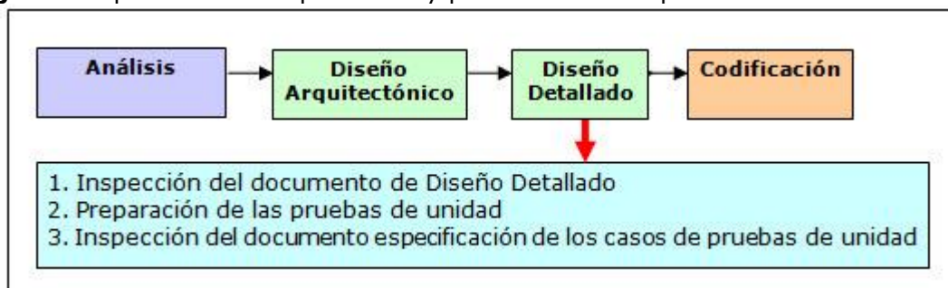
Figura 4. Aplicación de inspecciones y pruebas en la etapa de diseño detallado.
