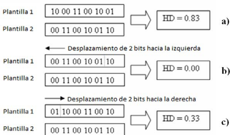
Fig. 2. Proceso de rotación de plantillas para el cálculo de la distancia de Hamming. a) Cálculo sin rotación b) Cálculo con rotación a la izquierda c) Cálculo con rotación a la derecha. En cada rotación se desplazan dos bits debido a que solo se utiliza un filtro para la codificación. Fuente (Daugman, 2004)
